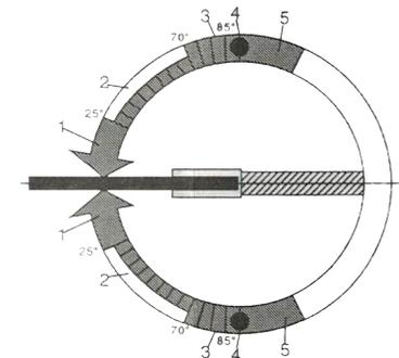
1. Faixa da porta: 20 graus -0 graus (no ajuste do parafuso da válvula 2)
