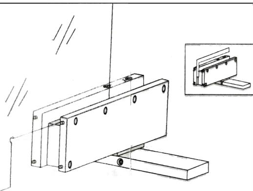
3. Com uma braçadeira e um eixo superior, na válvula reguladora na direção correta da junta sem amianto, o vidro é empurrado para dentro do corpo.
