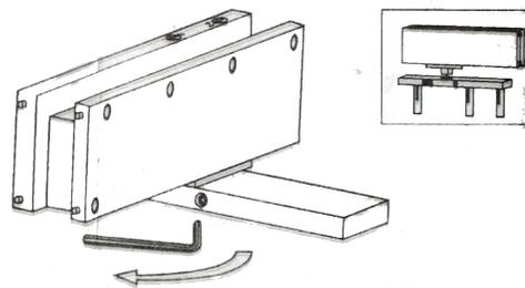
2. A placa principal na base está fixa, o parafuso da base afrouxa, alavancando a chave móvel ou as outras ferramentas vão se mover para a mola de 90 graus.
