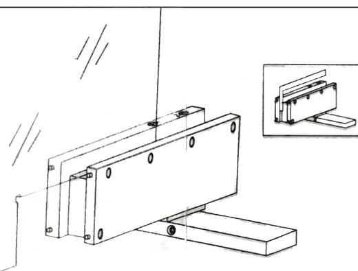
3. Com uma braçadeira e um eixo superior, na válvula reguladora na direção correta da junta sem amianto, o vidro é empurrado para dentro do corpo.
