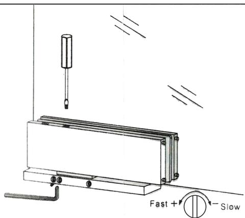
5. Teste o aperto fechado e ajuste os parafusos de alinhamento da base para corrigir a velocidade da válvula de ajuste de verticalidade, caso necessário, consulte a velocidade de "orientação".
