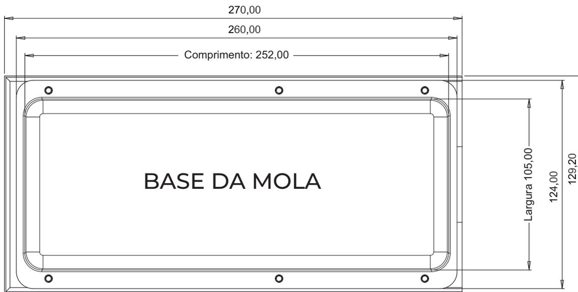
A furação para instalação, deve ser feito de acordo com o comprimento, largura e profundidade da base do produto.
