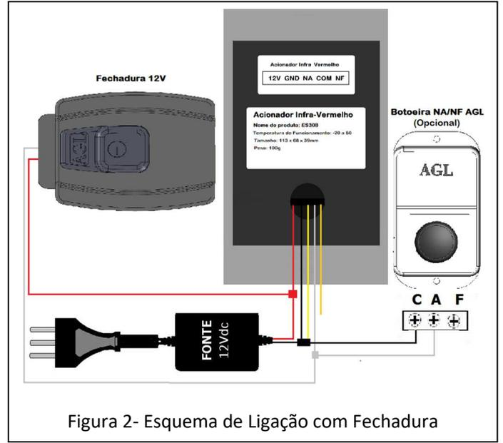
Figura 2- Esquema de Ligação com Fechadura
