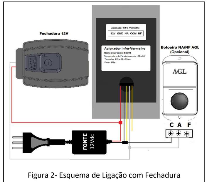
Figura 2- Esquema de Ligação com Fechadura
