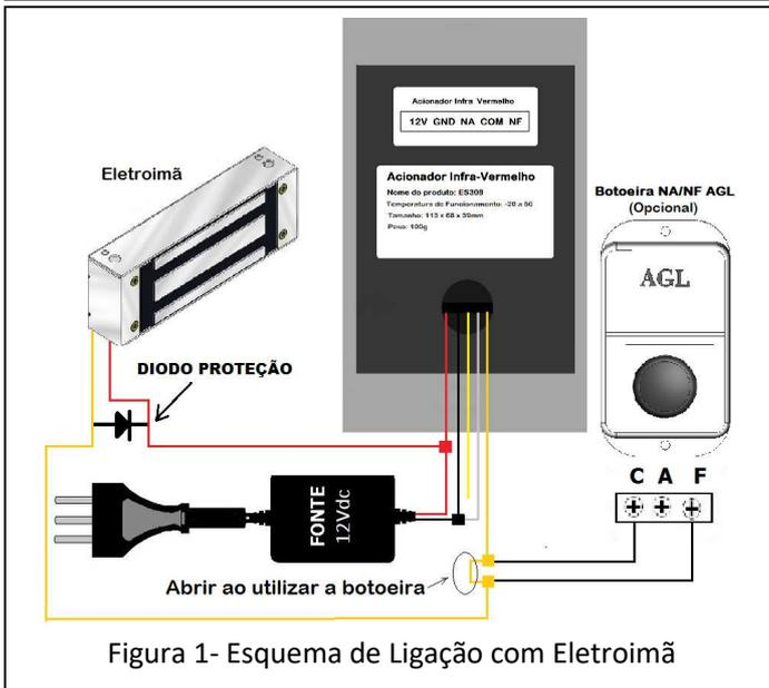
Figura 1- Esquema de Ligação com Eletroímã
