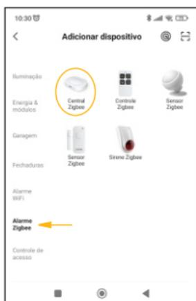
Na tela principal do aplicativo, toque em 'Adicionar Dispositivo' ou no sinal de adição no canto superior direito (como mostra a imagem ao lado) e em seguida, no menu lateral esquerdo, toque na aba **Alarme Zigbee**. Localize a Central Zigbee e acione um toque sobre o ícone da central para começar o processo de pareamento.
