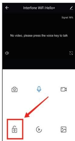
1 Para acionar a fechadura na tela inicial do interfone, pressione sobre o símbolo de cadeado, o mesmo mudará para aberto por um instante, indicando que um pulso foi enviado para a saída "FF" do módulo externo.
