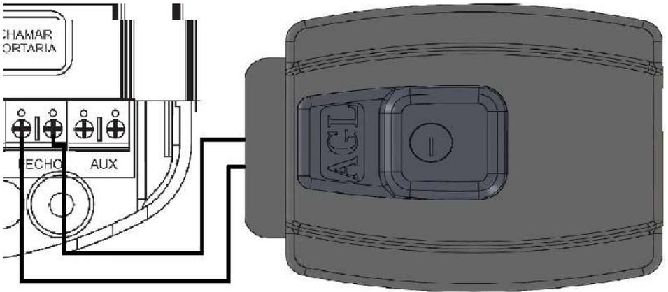
Conexión de dispositivo a la salida auxiliar
