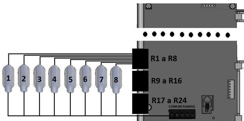
Figura 11- Pontos de Conexão dos Ramais PCD-24F
