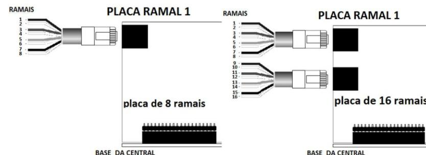
Figura 9- Identificação dos ramais (Placa de 8 e 16 ramais)
