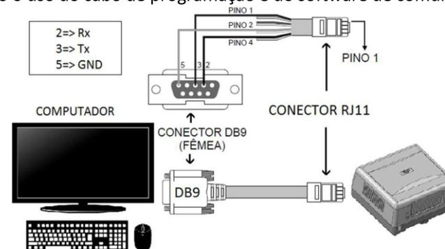
Figura 16 – Conexão da Central à um computador
