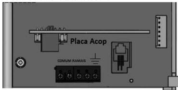
Figura 7- Slot de Conexão da Placa de Acoplamento
