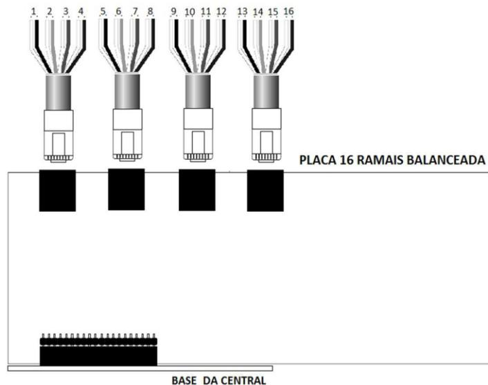
Figura 10- Identificação dos ramais (16 ramais Balanceada)
