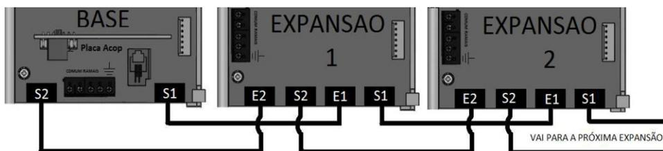
Figura 14- Conexão da Base com as Expansões
