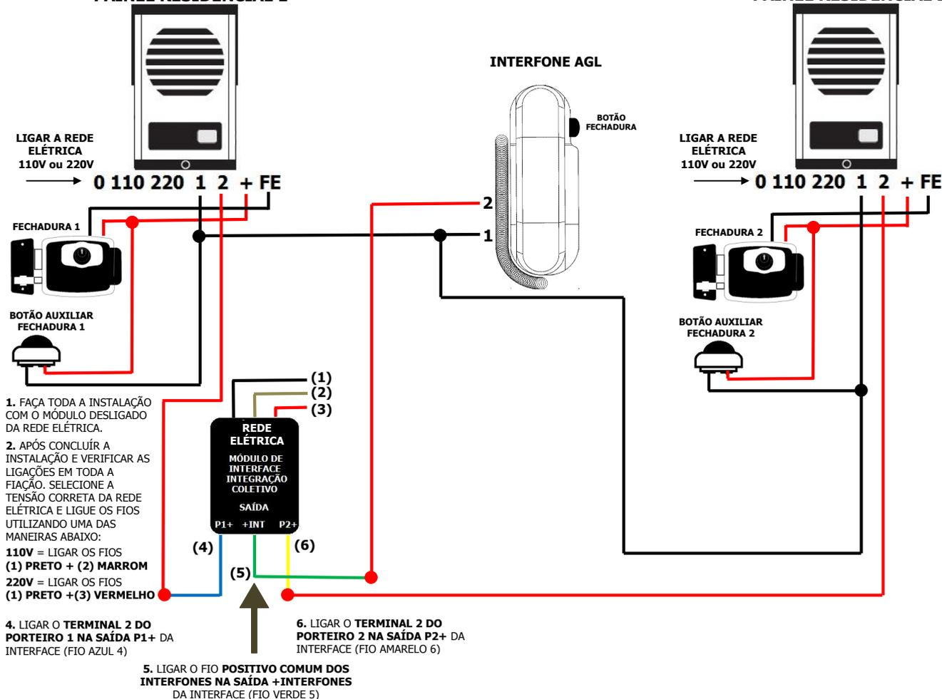
**DIAGRAMA DE INSTALAÇÃO: PORTEIRO COLETIVO AGL COM PLACA DE INTERFACE PARA INTEGRAR 2 PAINÉIS E ACIONAR 2 FECHADURAS 12V INDIVIDUALNEAMENTE.**
