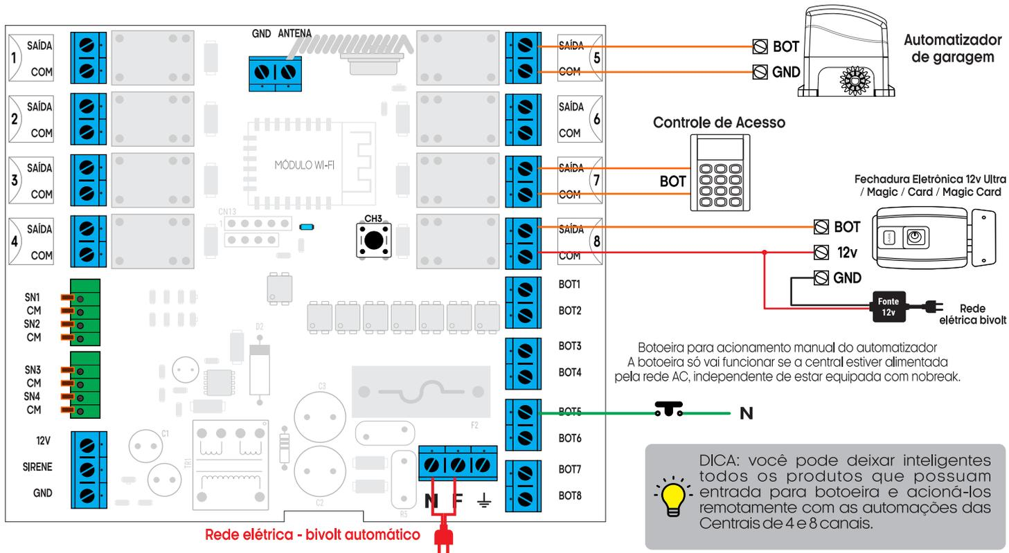
Os dispositivos que são equipados com entrada para botoeira podem ser ligados diretamente na Central. O exemplo acima mostra um automatizador, um controle de acesso e uma fechadura eletrônica (todos possuem a entrada para botoeira). Eles podem ser ligados em quaisquer canais (do 1 ao 8). Esse tipo de produto pode utilizar uma botoeira na saída respectiva do canal instalado.
