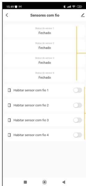
Mostra o status dos sensores com fio em tempo real. Os status podem ser utilizados para criar diversas automações.
