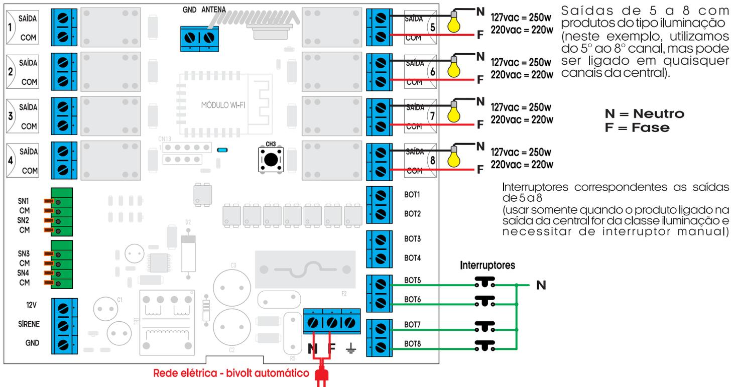
A Central pode gerenciar até 4 / 8 ambientes ou pontos de iluminação. Para cada canal, faça a ligação do interruptor do canal correspondente nas saídas BOT. Os interruptores são utilizados somente quando a saída do canal for do tipo iluminação e funcionam como interruptores de acionamento manual. Os outros tipos de produtos não necessitam do interruptor.
