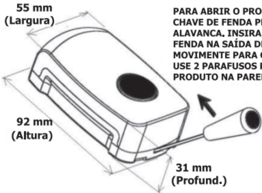
PARA ABRIR O PRODUTO USE UMA CHAVE DE FENDA PEQUENA COMO ALAVANCA. INSIRA A CHAVE DE FENDA NA SAÍDA DE CABOS E MOVIMENTO PARA CIMA. USE 2 PARAFUSOS PARA FIXAR O PRODUTO NA PAREDE.
