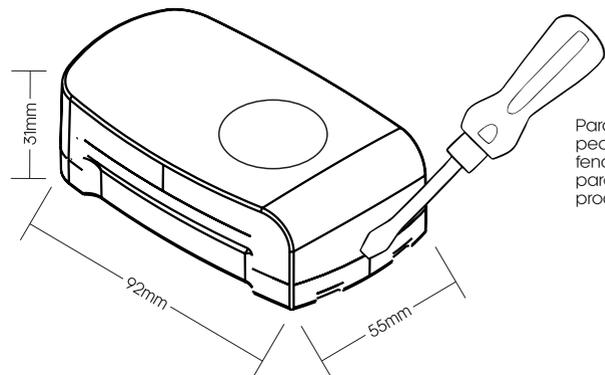
Para abrir el producto, use una llave de fenda pequeña como palanca. Inserte la llave de fenda en la salida de los cables e inclínese hacia arriba. Use dos tornillos para fijar el producto a la pared.
