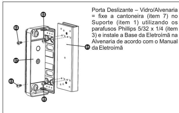
Porta Deslizante – Vidro/Alvenaria = fixe a cantoneira (item 7) no Suporte (item 1) utilizando os parafusos Phillips 5/32 x 1/4 (item 3) e instale a Base da Eletroimã na Alvenaria de acordo com o Manual da Eletroimã
