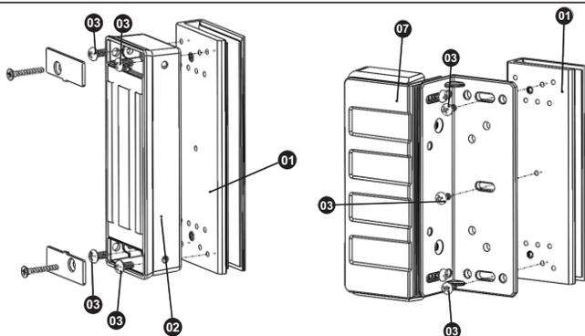
Porta Pivotante – Vidro / Vidro = fixe a cantoneira (item 7) no Suporte (item 1) utilizando os parafusos Phillips 5/32 x 3/8 (item 3) e na outra porta, fixe a base da Eletroimã (item 2) no Suporte (item 1) utilizando os parafusos Phillips 5/32 x 3/8 (item 3).
