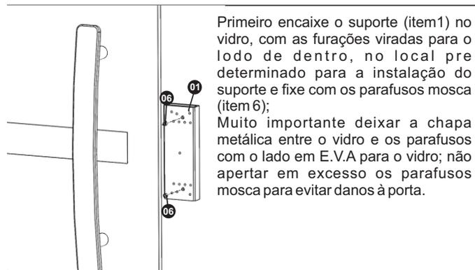
Primeiro encaixe o suporte (item 1) no vidro, com as furações viradas para o lado de dentro, no local pre determinado para a instalação do suporte e fixe com os parafusos mosca (item 6);
