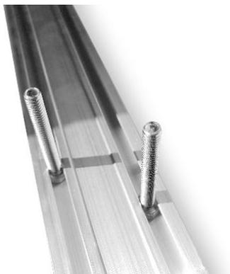
Coloque os parafusos na ranhura da guia do braço estrutural de alumínio e, em seguida, coloque uma placa de suporte onde o centro dos parafusos coincida e prenda-o à parede ou à estrutura metálica.
